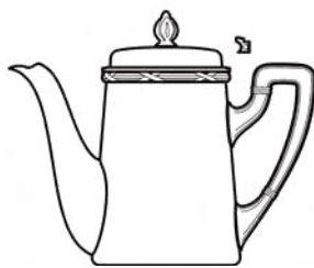
9 Saldatura cerniera Hinge welding
